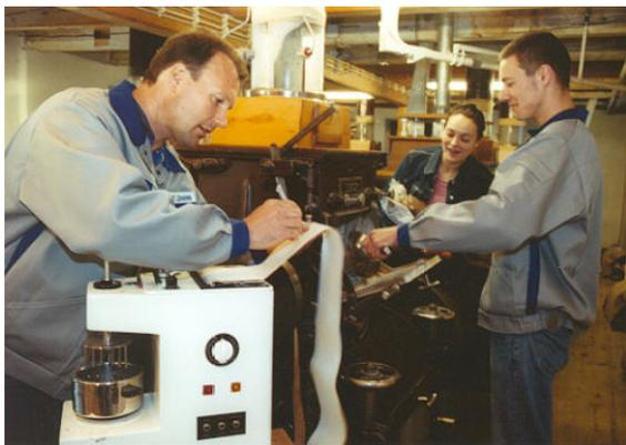
Der Walzenstuhl ist mit 150 Jahren Tradition die wichtigste Maschine der Müllerei. Er sorgt zunächst für die schonende Zerkleinerung des Getreides. Danach folgt die Trennung des zerkleinerten Materials nach Teilchengröße durch die Siebe im Plansichter. "Sichten" ist der mahlentechnische Fachausdruck für das Sieben. Und wie ein Walzenstuhl funktioniert, erklärt der Ausbilder (links im Bild): "Innen drin befindet sich ein Walzenpaar. Die eine Walze
