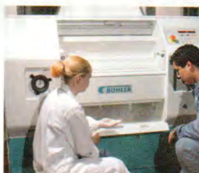
im Walzenstuhl das Getreide schonend zu Schrot zerkleinern und zu Mehl mahlen ...
