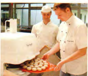
mit der Teigteilmaschine gleich große Teiglinge portionieren ...
