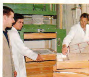
im Plansichter die Mahlerzeugnisse nach Teilchengröße trennen und aussieben.
