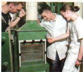
mit dem Steigsichter leichte Teilchen (die „Spreu“) im Luftstrom von Körnern trennen ...
