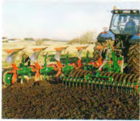
Mit Pflug und Packer den Boden tief lockern, wenden, rückverfestigen und bearbeiten ...
